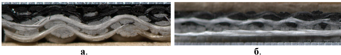
Рис. 8 – Фотографии срезов МКПТ: а- вдоль основных; б- вдоль уточных нитей
